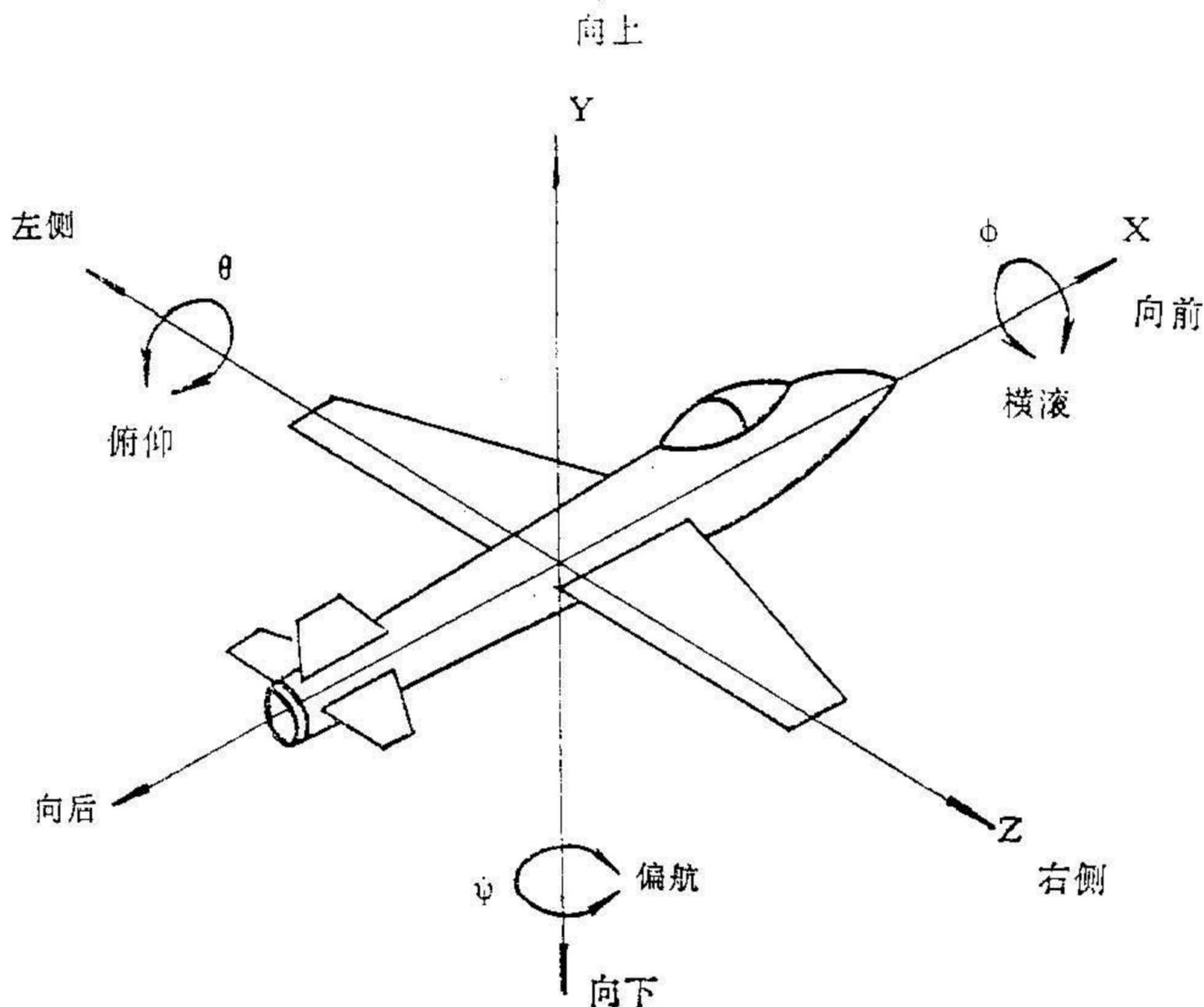
飞机的加速度方向示意图
